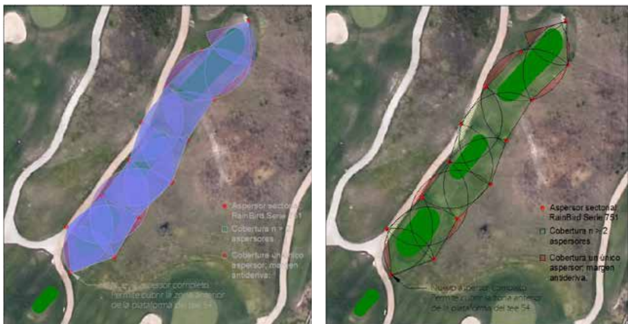
Imagen 6. Cobertura de los aspersores tras la reforma en tees 65, 59 y 54 del Hoyo 4. Obsérvese que la superficie regada es menor gracias al empleo de aspersores sectoriales.
