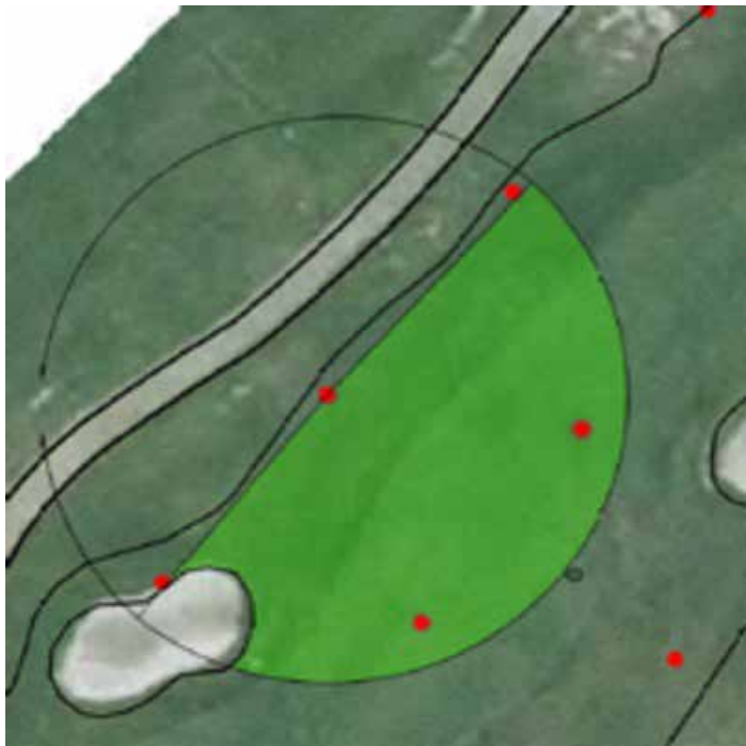
Imagen 7. Modelización del área regada por un aspersor sectorizado. Permite ahorrar agua de una forma considerable regando exclusivamente la zona seleccionada, en este caso el 50% de su zona de influencia.
